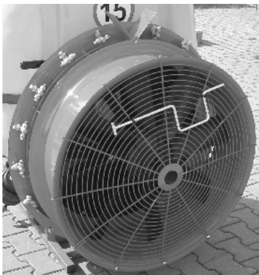
Рис. 6. Вентиляторные приставки: а - традиционная (низкая), б - колонная
