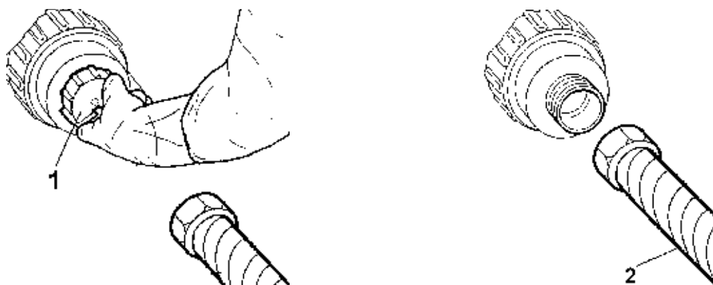
Рис. 4. Заполнение резервуара через всасывающий фильтр: 1 – поворотная ручка блокировки клапана, 2 – всасывающий шланг
