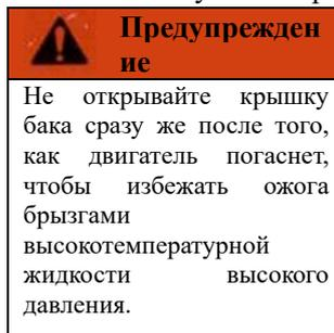
Предупреждающий знак против ожога. Наклеить на водяном баке. Предупредить, что после работы трактора температура во водяном баке высокая, запрещается касаться вручную во избежание случайной опасности.
