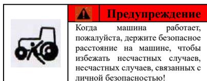
Держите предупреждающий знак безопасного расстояния с машиной. Вставьте по обеим сторонам крыла. Предупреждайте пользователя о том, чтобы при работе машины оставить подальше от её и избежать несчастных случаев.
