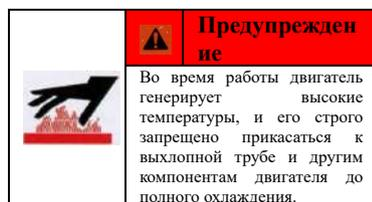
Предупреждающий знак против ожога. Вставьте на левую и правую стороны двигателя, глушителя и резервуара для воды. После работы трактора температура выхлопной трубы и бака для воды высока, а горячая поверхность будет гореть человеческим телом. Запрещается прикасаться до полного охлаждения, чтобы избежать случайной опасности.
