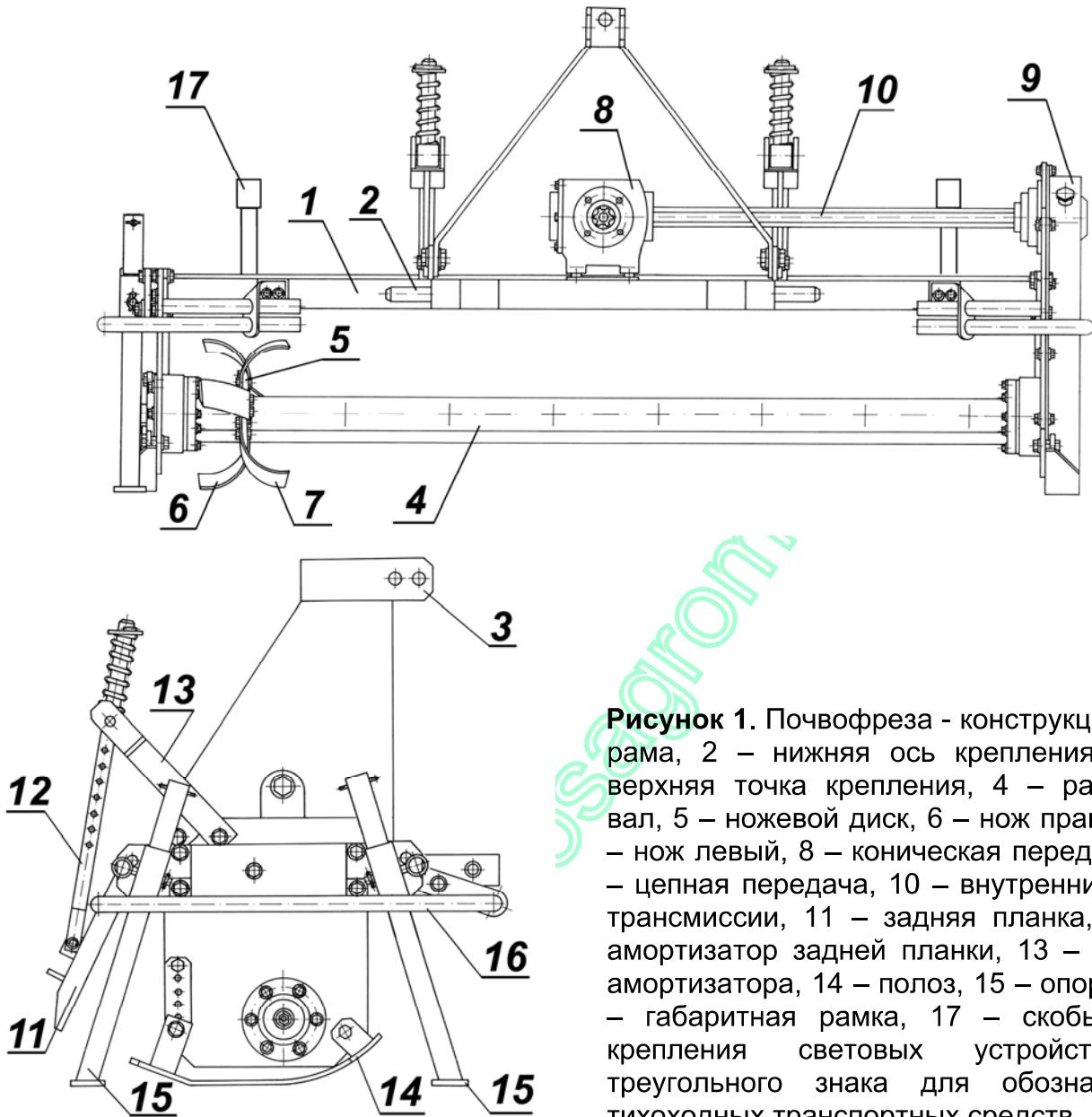
**Рисунок 1.** Почвофреза - конструкция: 1 - рама, 2 - нижняя ось крепления, 3 - верхняя точка крепления, 4 - рабочий вал, 5 - ножевой диск, 6 - нож правый, 7 - нож левый, 8 - коническая передача, 9 - цепная передача, 10 - внутренний вал трансмиссии, 11 - задняя планка, 12 - амортизатор задней планки, 13 - плечо амортизатора, 14 - полоз, 15 - опоры, 16 - габаритная рамка, 17 - скобы для крепления световых устройств и треугольного знака для обозначения тихоходных транспортных средств
