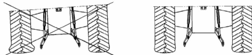
Давление воздуха особенно в задних колесах трактора должно быть одинаковым для двух колес и соответствовать значению, указанному в инструкции!
